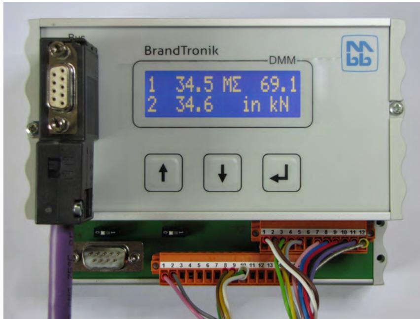
Modular aufgebautes, rechnerbasiertes, zwei- bis vierkanaliges Messsystem für Messwertaufnehmer mit Dehnmessstreifen (DMS-MWA).
